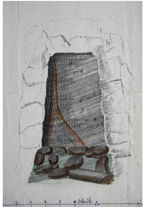
Obr. 12. Lichobežníkový profil ručne vyrazenej štôľne (kresanice) Sv. Michal v rovnomennej starej striebornej bani na Malom Gápľi zobrazenej na banskom výkrese z roku 1772 (SBA BS, f. HKG, inv. č. 9197).
