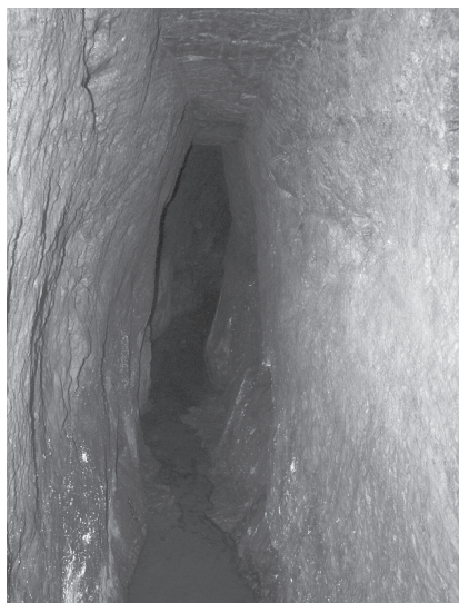
Obr. 4. Stredoveká kresanica v doline Jasenianskeho potoka vyrazená ručným rozpojovaním železkom a kladivkom (foto M. Žec).
