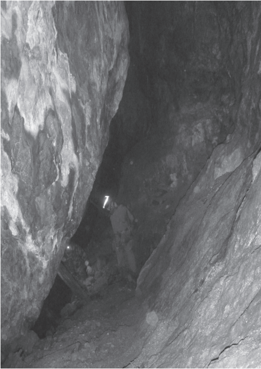
Obr. 8, 9. Rozsiahle hlbinné dobýjky (vyťažené žily) v bani Brezinka na Veľkom Gápli vytvorené s použitím ohňa a ručného rozpojovania železkom a kladivkom (foto M. Budaj).
