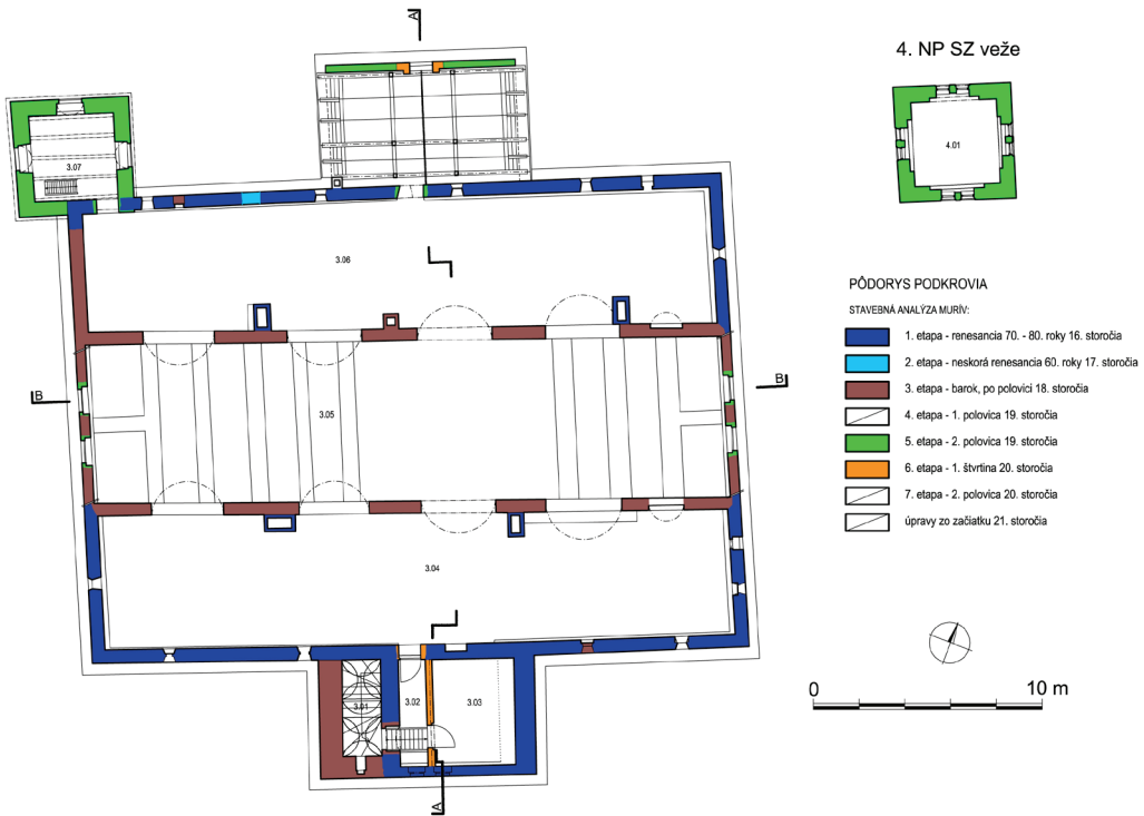
Obr. 7. Pôdorys kaštieľa v úrovni podkrovia, 3. NP a 4. NP severozápadnej veže - slohová analýza. Autor: Miroslav Matejka.
